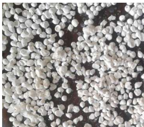
Рис. 2.11. Сформованные влажные (а) и лиофильно высушенные (б) гранулы ХЗ/ГА=70:30 масс.% на основе хитозана Bombyx mori
