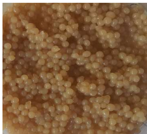
Рис. 2.11. Сформованные влажные (а) и лиофильно высушенные (б) гранулы ХЗ/ГА=70:30 масс.% на основе хитозана Bombyx mori
